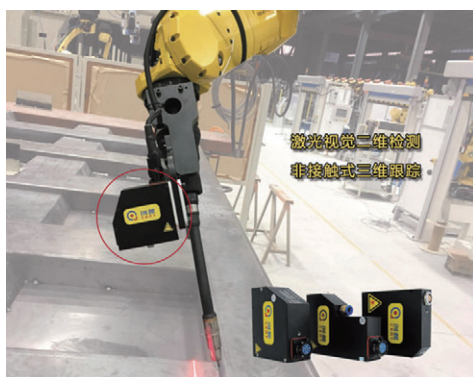
图 2 激光焊缝跟踪系统 Fig.2 Laser seam tracking system
